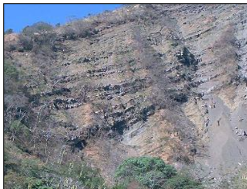
Fotos 1-Basaltos: masivos alterados en cabecera (izq), alternancia con piroclastos (centro), masivos en ladera baja (derch).
